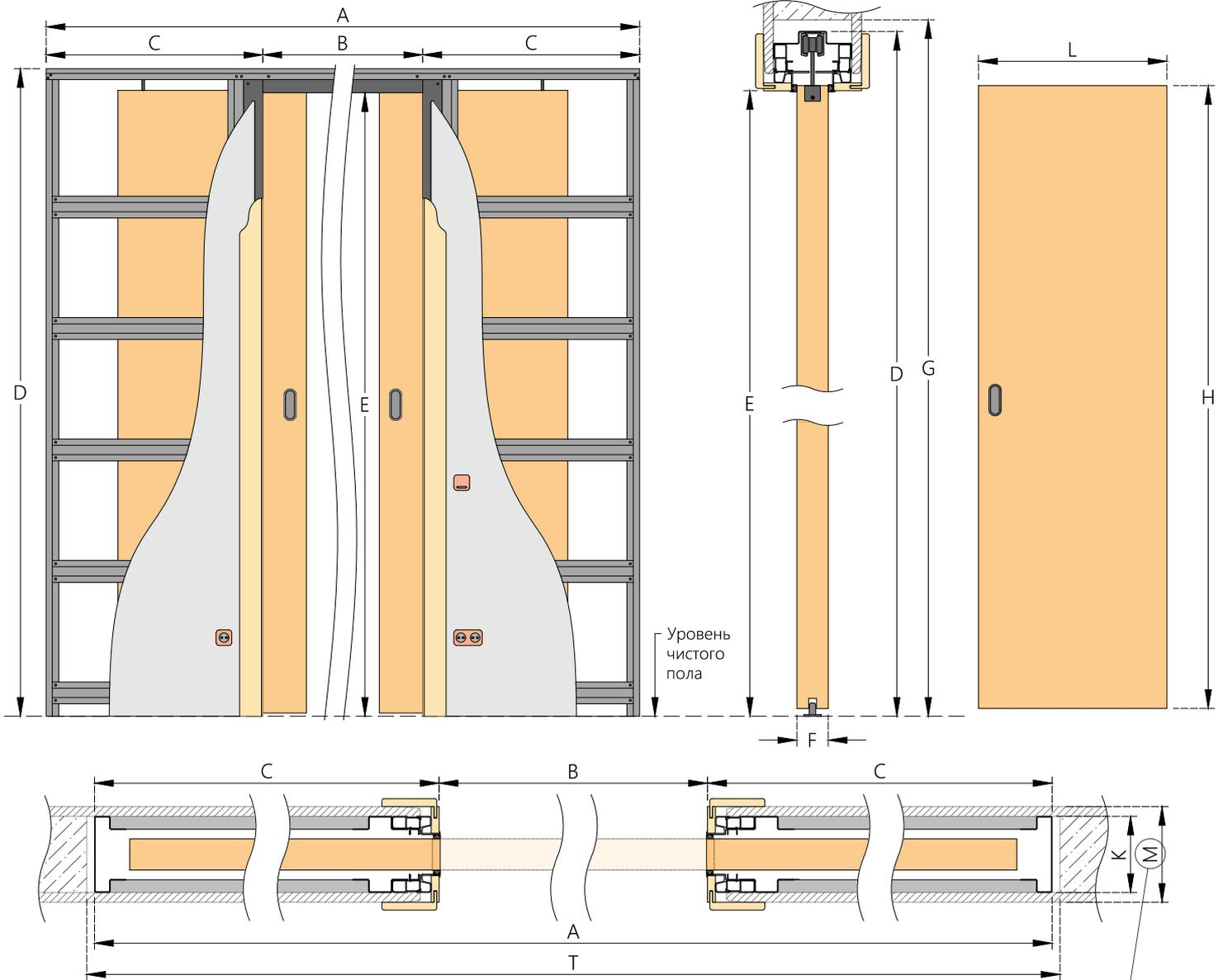
\* Толщина готовой стены (М) рассчитана при отделке с двух сторон одним листом ГКЛ - 12,5 мм, может изменяться в зависимости от применяемых материалов
